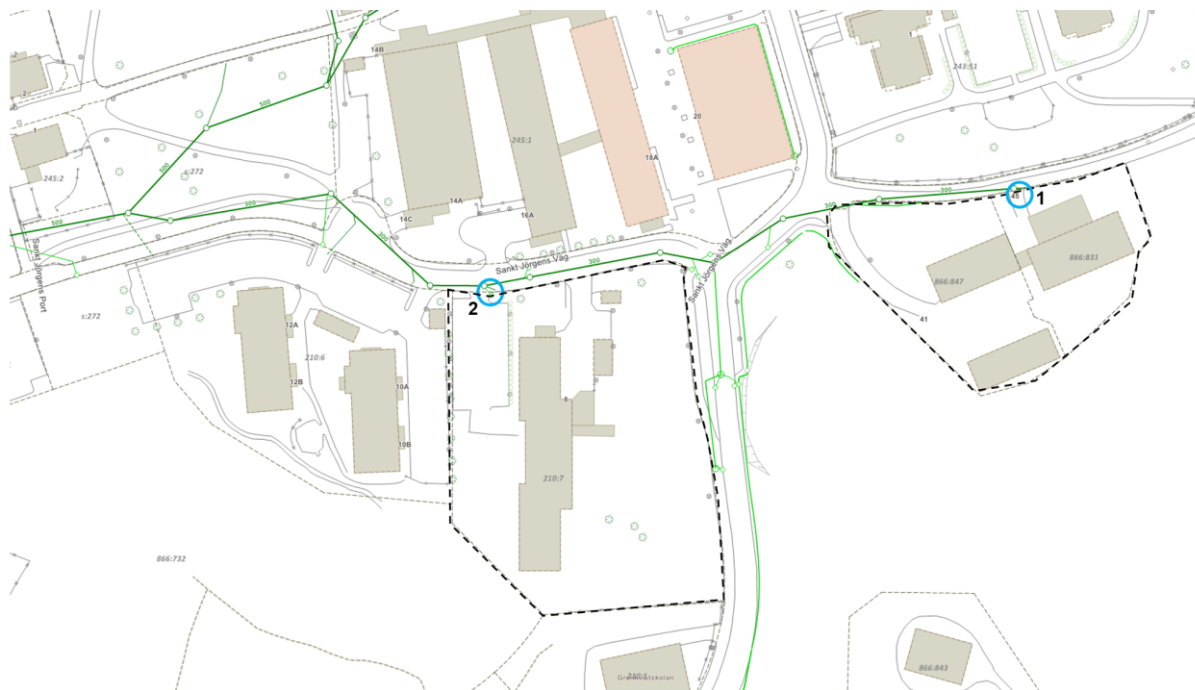
Figur 11 Utdrag från VA-banken som visar ledningsnätet vid aktuellt planområdet. Planområdesgränsen är ungefärligt markerad. Punkterna 1 och 2 markerar motsvarande brunnar i Figur 12.
